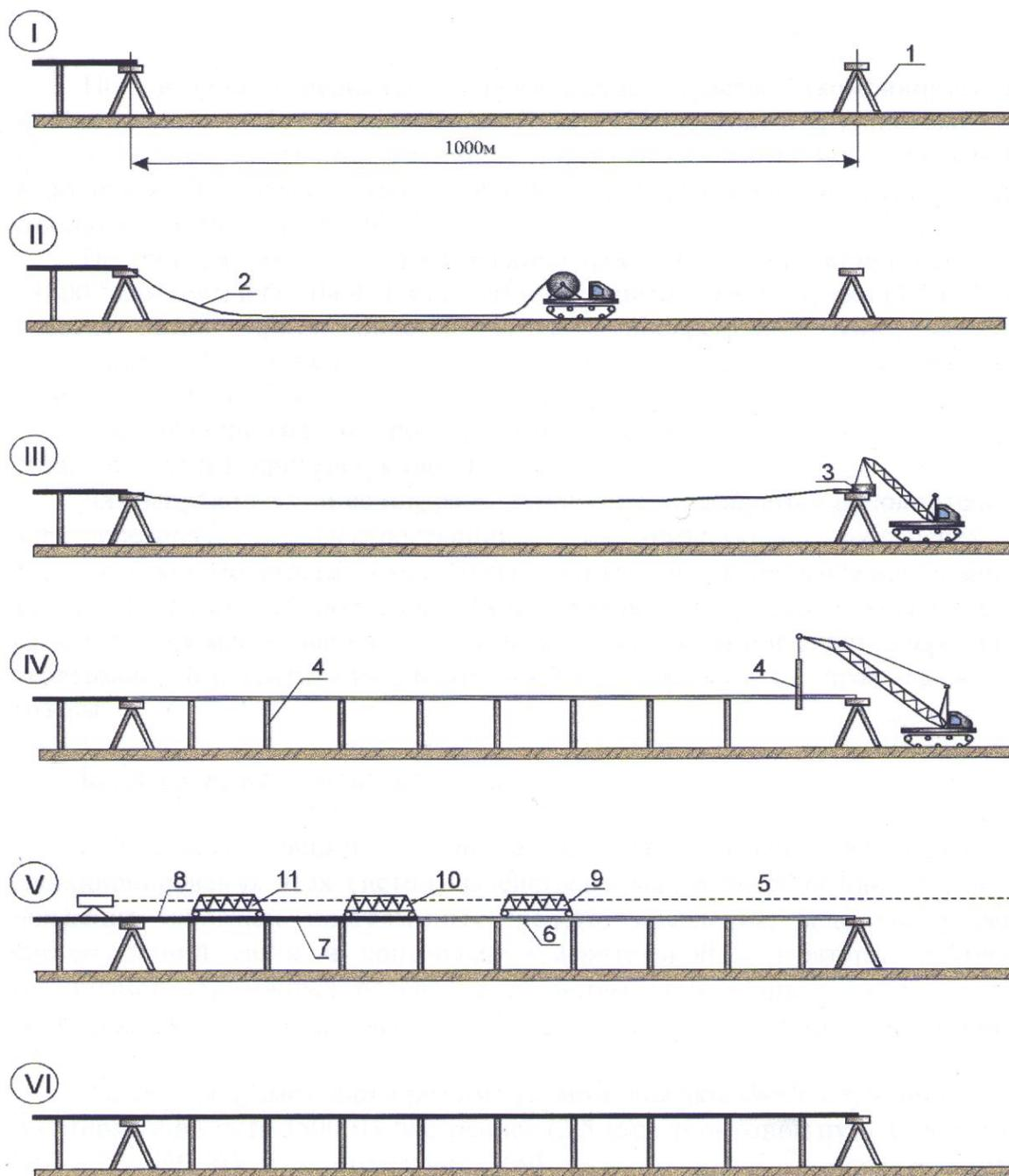
Рис. 8. Технология строительства трассы СТС:
