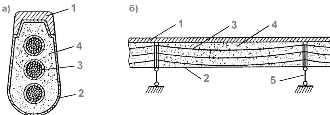
Рис.2. Конструкция рельса-струны:
