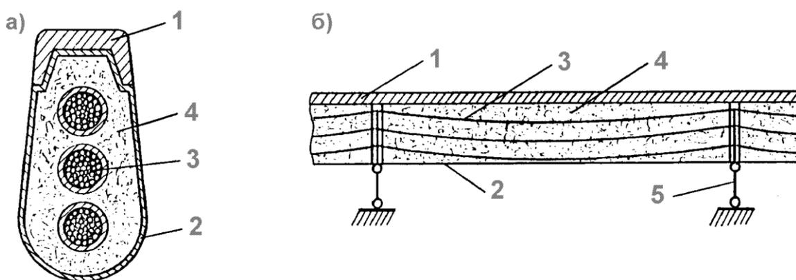
Рис. 2. Конструкция рельса-струны:
