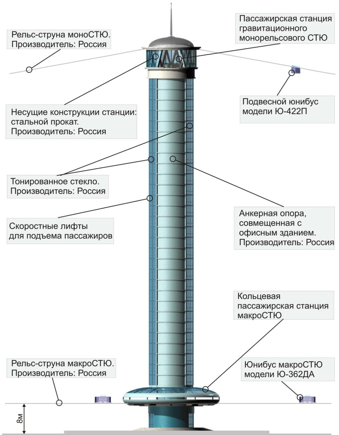
Рис. 4.7. Анкерная опора-здание гравитационного монорельсового СТЮ высотой около 100 м, совмещенная с пассажирской станцией на городской трассе макроСТЮ (общий вид)
