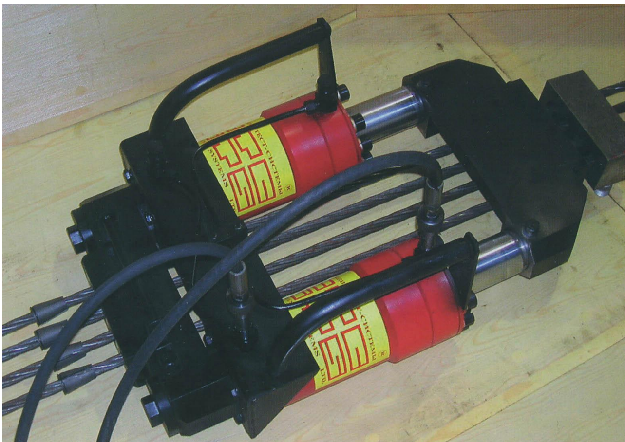
Рис. 2.5. Технологическое оборудование для натяжения ряда из четырех канатов диаметром 15 мм
