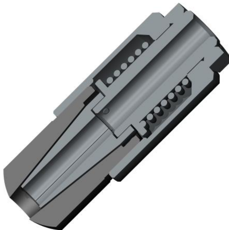
Рис. 4. Полуавтоматический анкерный зажим А14132-12301000 для крепления каната и арматуры (продольный разрез)
