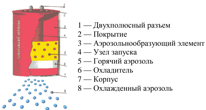
Рис. 17. Устройство генератора огнетушащего аэрозоля МАГ
