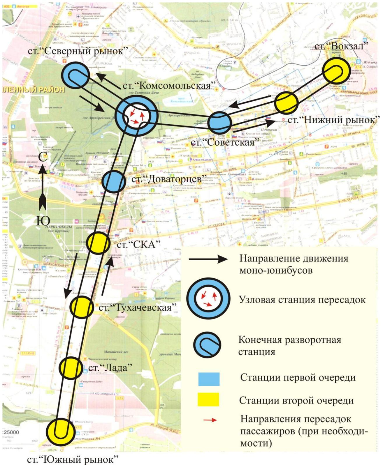
Рис. 4.4. Схема организации кольцевого движения моно-юнибусов в городе Ставрополе (без использования стрелочных переводов на станциях и на трассе) в третьем варианте трассировки
