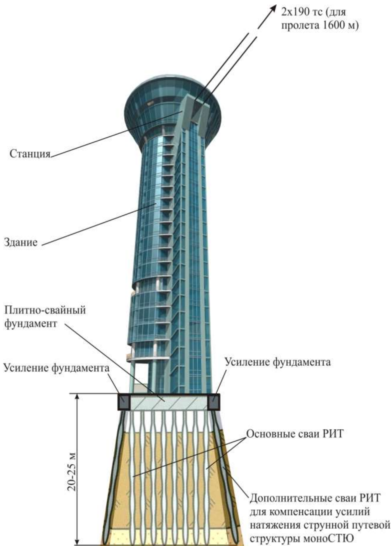
Рис. 3.1. Фундаментное основание высотного здания-станции на «супер-сваях» РИТ
