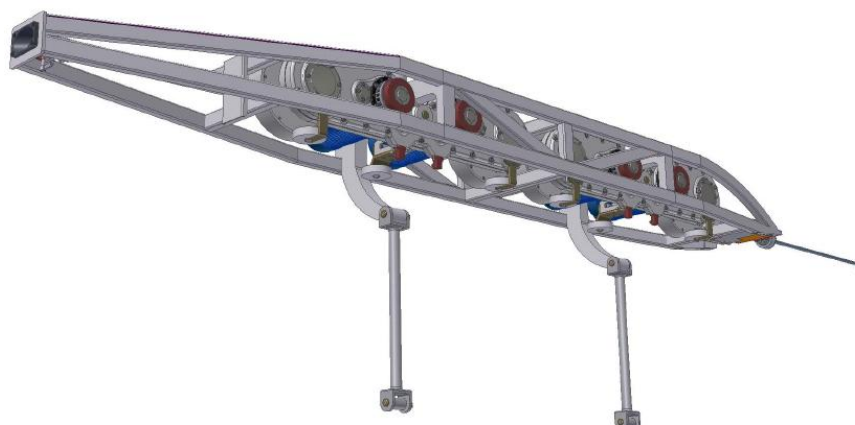
Рис. 1.14. Шасси моно-юнибуса Ю-373П (вид на носовую часть)
