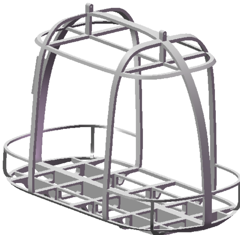
Рис. 1.28. Каркас сварной кабины моно-юнибуса Ю-373П исполнения 01
