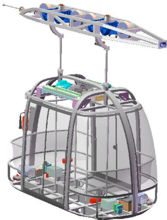
Рис. 1.11. Компоновка моно-юнибуса Ю-373П исполнения 01 (вид на носовую часть)
