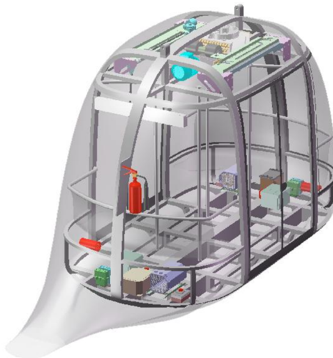
Рис. 1.26. Кабина моно-юнибуса Ю-373П исполнения 01 (вид на кормовую часть)
