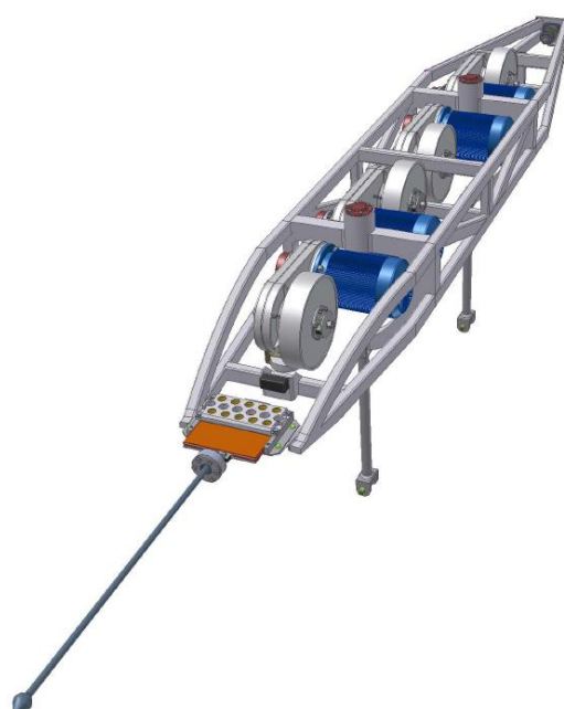
Рис. 1.15. Шасси моно-юнибуса Ю-373П (вид на кормовую часть)
