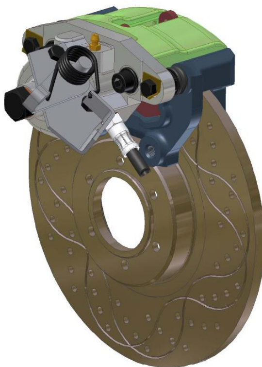
Рис. 24. Задний тормозной суппорт с диском юнибуса Ю-314П
