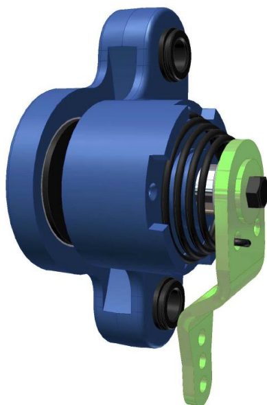
Рис. 25. Механический суппорт стояночной тормозной системы юнибуса Ю-315П
