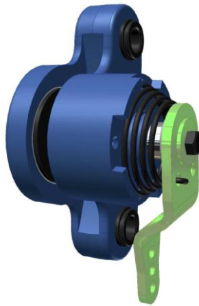
Рис. 26. Механический суппорт стояночной тормозной системы юнибуса Ю-321П
