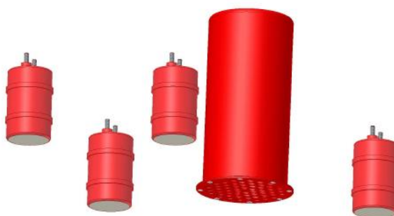
Рис. 39. Генератор огнетушащего аэрозоля МАГ-5/1 и датчики температуры
