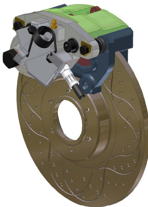
Рис. 25. Задний тормозной суппорт с диском юнибуса Ю-321П
