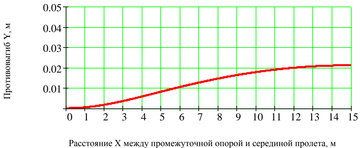
Рис. 2.15. Половина кривой противовыгиба от 0 метров (опора) до 15 метров (середина пролета); вторая ветвь кривой (не показана) — симметрична относительно середины пролета
