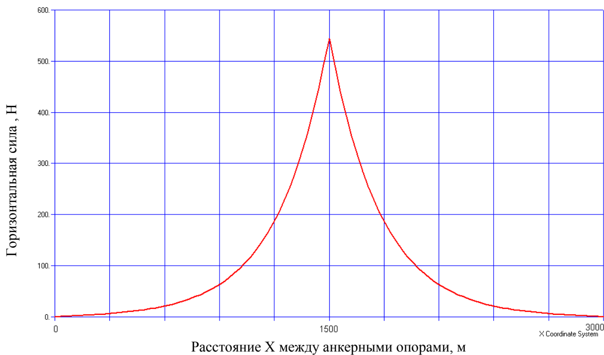
Рис. 2.14. График нагружения горизонтальными силами верха промежуточных опор двумя юнибусами в сцепке, тормозящих одновременно в середине между анкерными опорами
