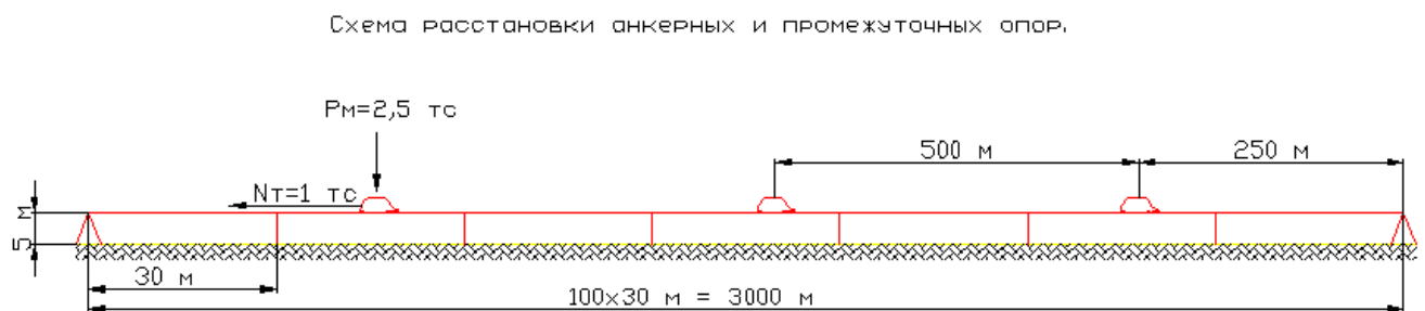
Рис. 2.12. Расчетная схема нагружения опор шестью модулями
