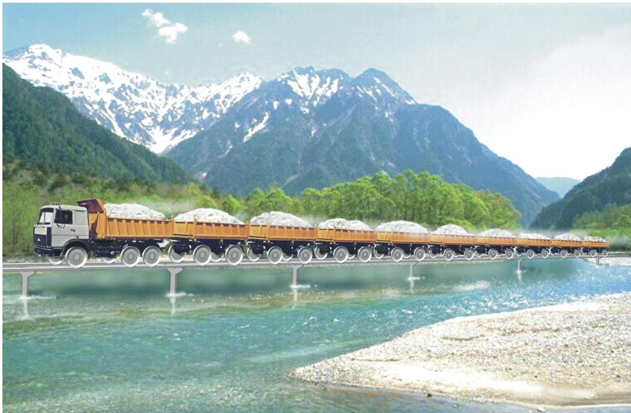
Рис. 3.24. Вариант грузовой трассы бирельсового СТЮ для перевозки сыпучих материалов
