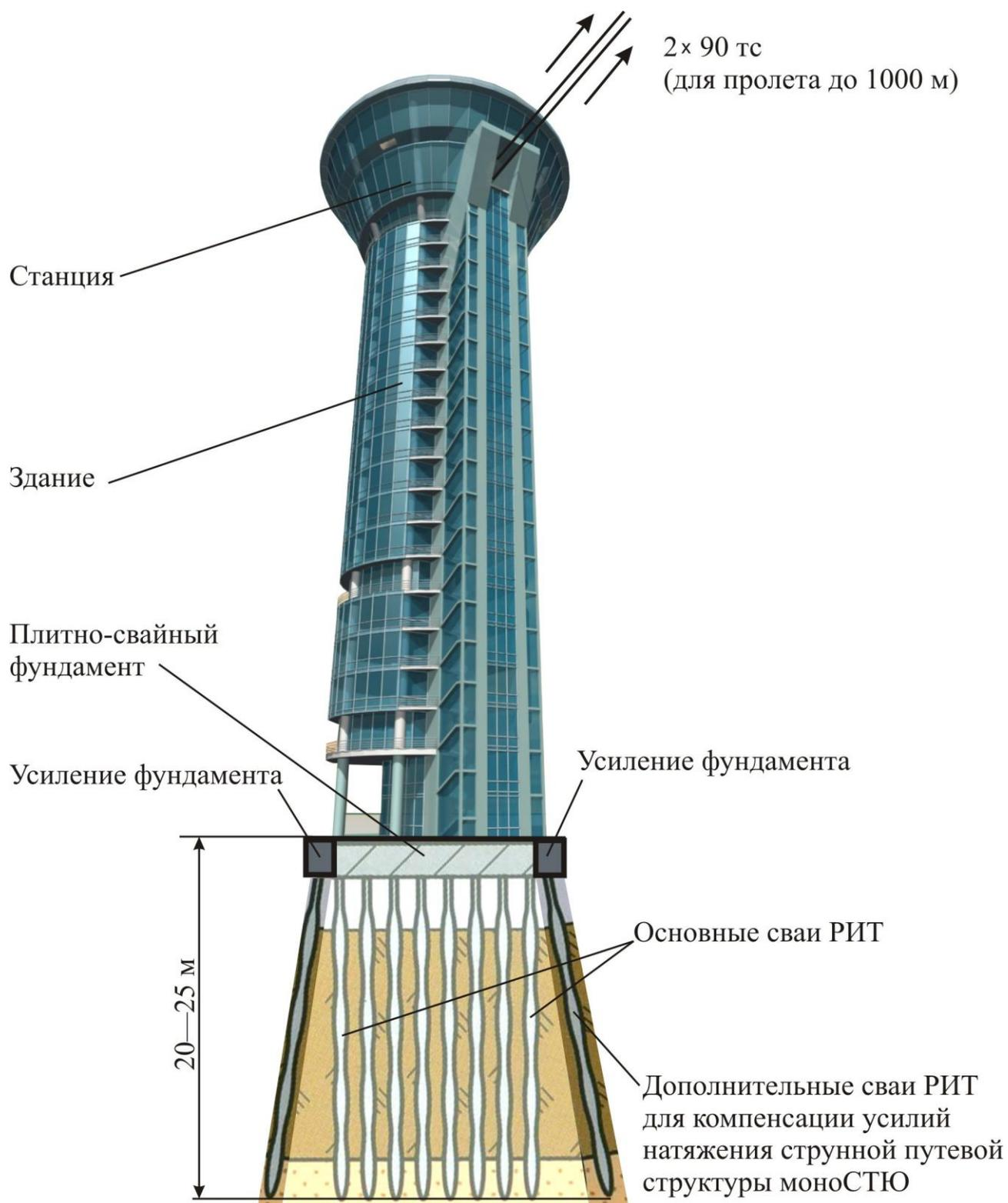
Рис. 1.20. Фундаментное основание высотного здания-станции СТЮ на «супер-сваях» РИТ
