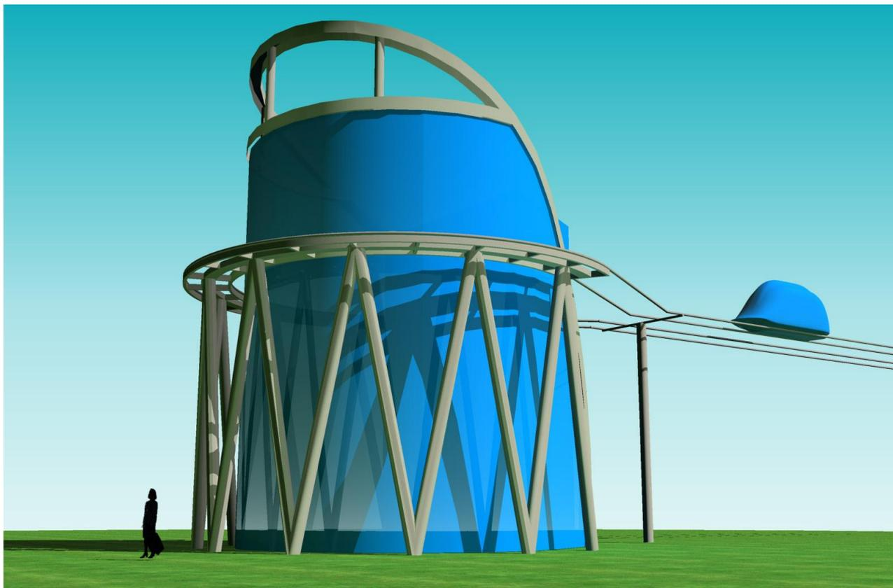
Рис. 2.19. Разворотная станция двухпутного бирельсового СТЮ с наружным несущим каркасом
