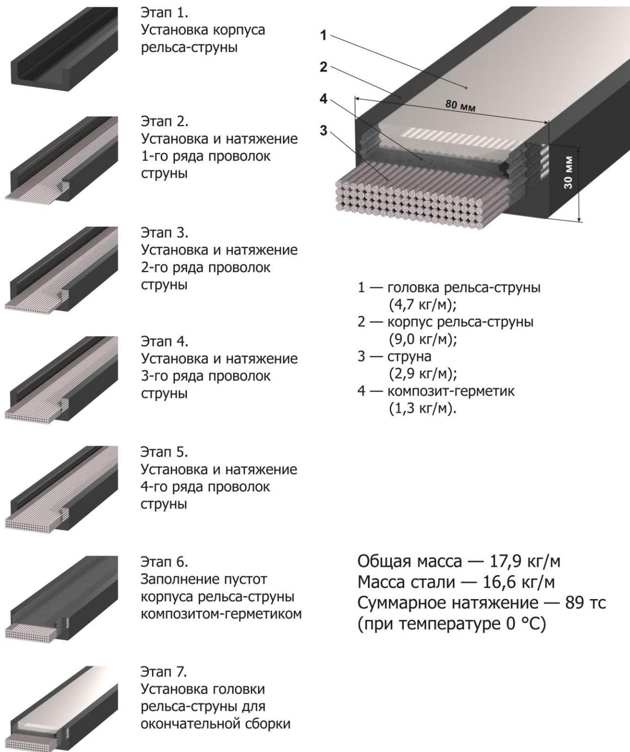
Рис. 3.7 Конструкция и этапы сборки рельса-струны среднего моноСТЮ
