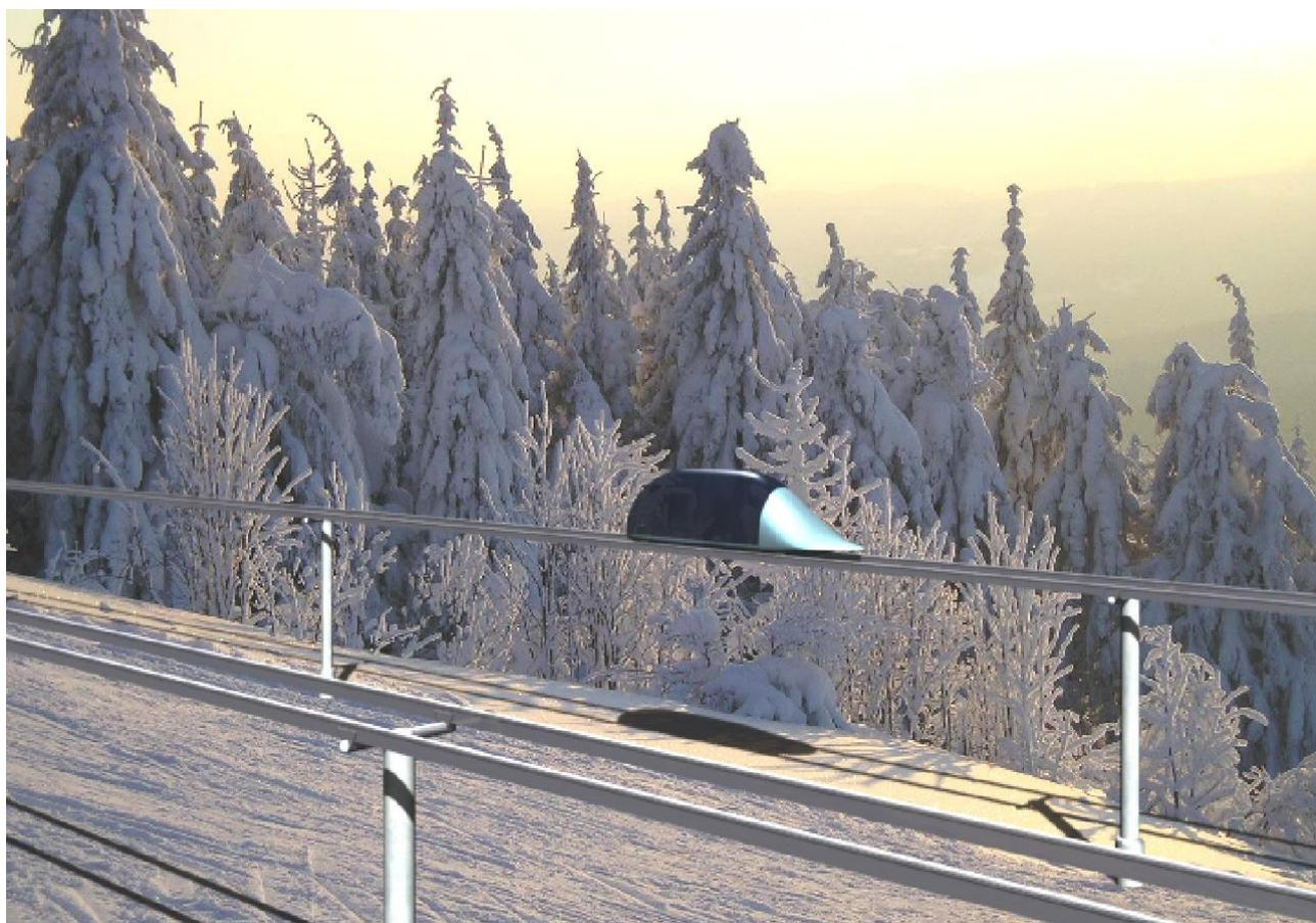
Рис. 3.18. Высокоскоростная междугородная трасса двухпутного бирельсового СТЮ колеи 1,5 м
