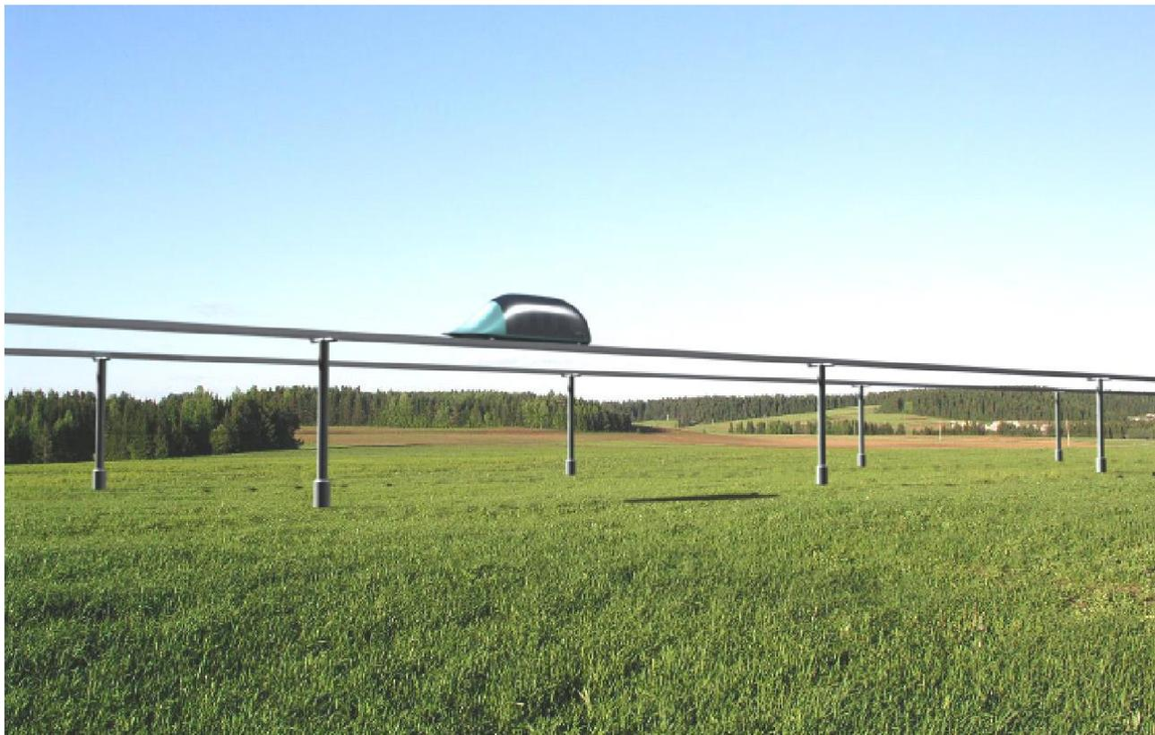
Рис. 3.17. Высокоскоростная междугородная трасса двухпутного бирельсового СТЮ колеи 1,5 м
