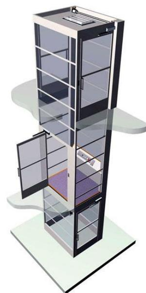
Рис. 2.33. Схема установки дверей на этаже
