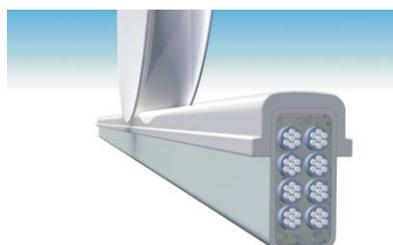
Рис. 3.8. Конструкция рельса-струны и колеса
