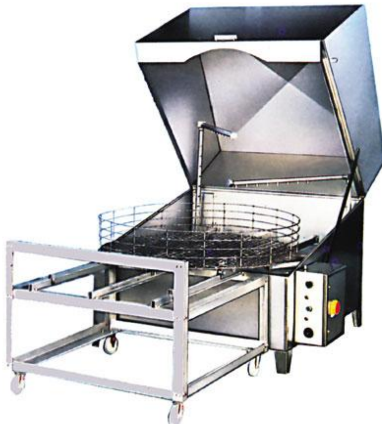
Рис. 10.39. Установка для мойки деталей «X30 L 331 V»
