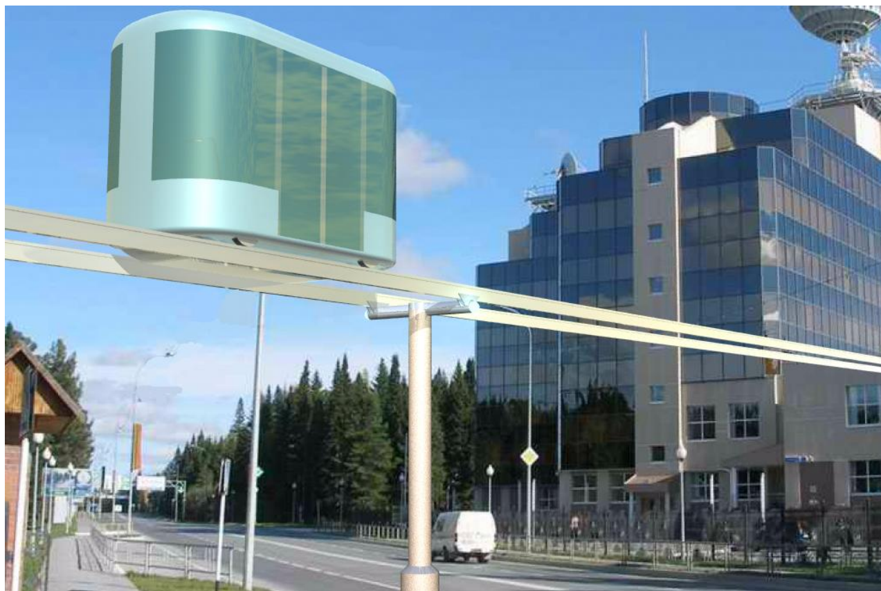
Рис. 1.1. Средний двухрельсовый СТЮ (показан вариант городской трассы двухрельсового СТЮ в г. Ханты-Мансийске)
