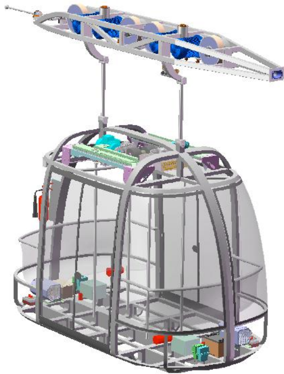
Рис. 1.9. Компоновка моно-юнибуса модели Ю-372П исполнения 01 (вид на носовую часть)
