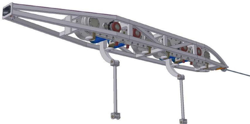
Рис. 1.12. Шасси моно-юнибуса модели Ю-372П (вид на носовую часть)
