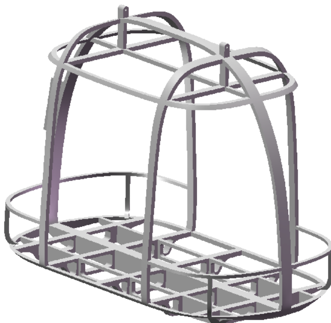
Рис. 1.25. Каркас сварной кабины моно-юнибуса модели Ю-372П исполнения 01
