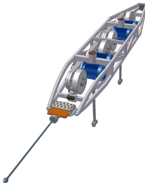
Рис. 1. 13. Шасси моно-юнибуса модели Ю-372П (вид на кормовую часть)
