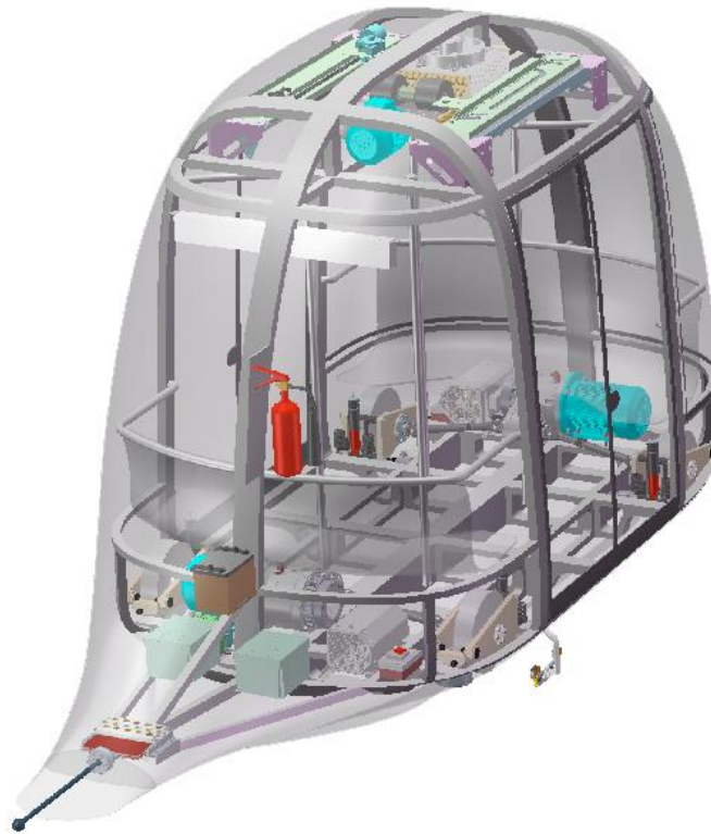
Рис. 1.17. Компоновка юнибуса Ю-324П исполнения 01 (вид на кормовую часть)
