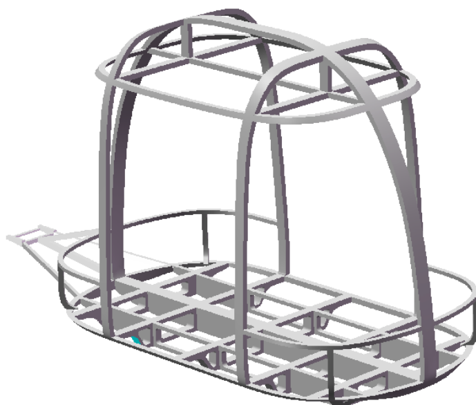
Рис. 1.23. Каркас сварной юнибуса Ю-324П исполнения 01
