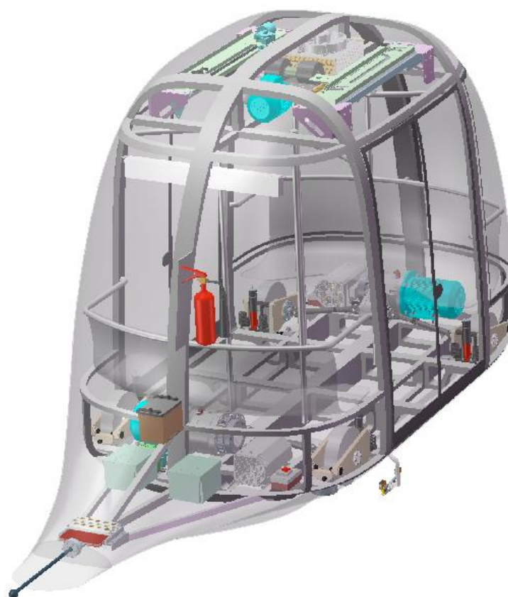
Рис. 1.18. Компоновка юнибуса Ю-325П исполнения 01 (вид на кормовую часть)
