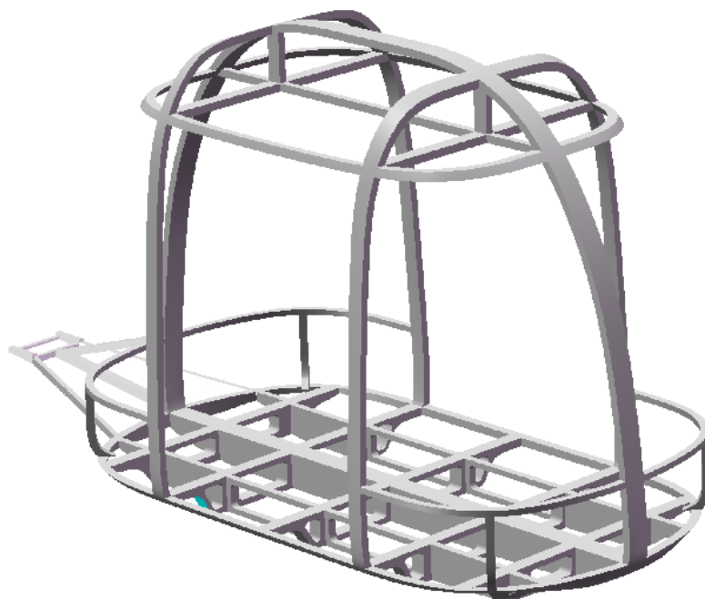
Рис. 1.24. Каркас сварной юнибуса Ю-325П исполнения 01
