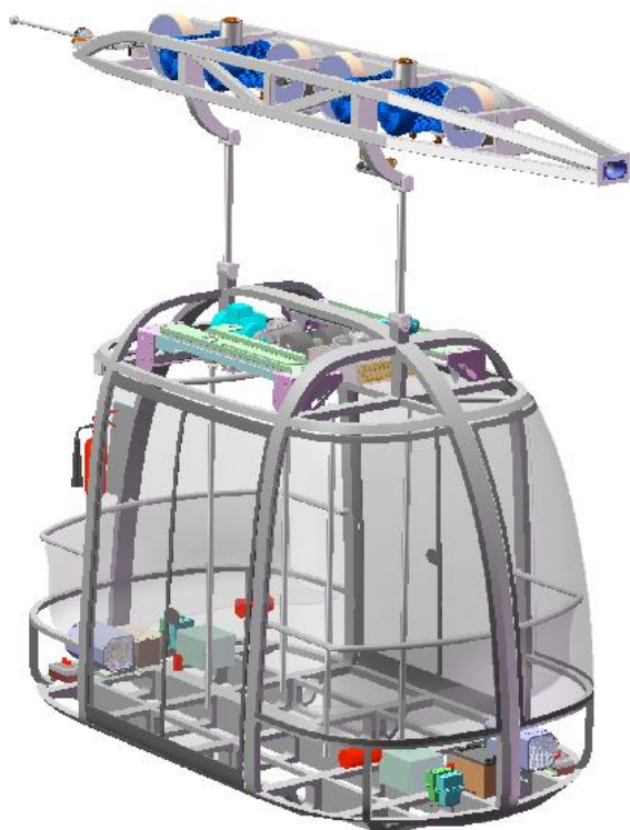
Рис. 1.11. Компоновка моно-юнибуса Ю-373П исполнения 01 (вид на носовую часть)
