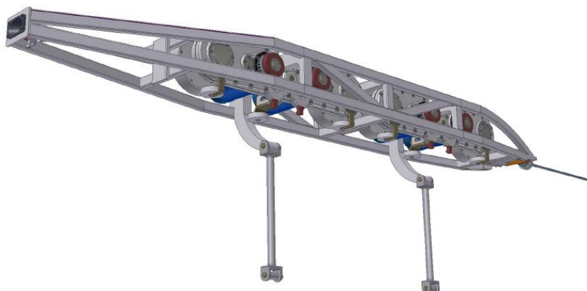
Рис. 1.14. Шасси моно-юнибуса Ю-373П (вид на носовую часть)
