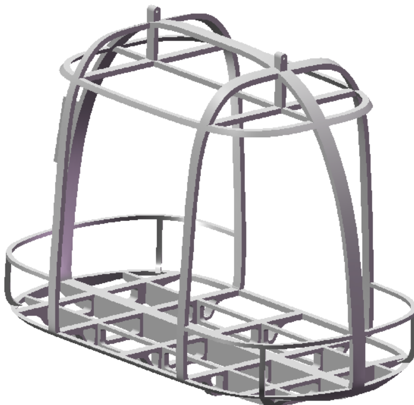
Рис. 1.28. Каркас сварной кабины моно-юнибуса Ю-373П исполнения 01
