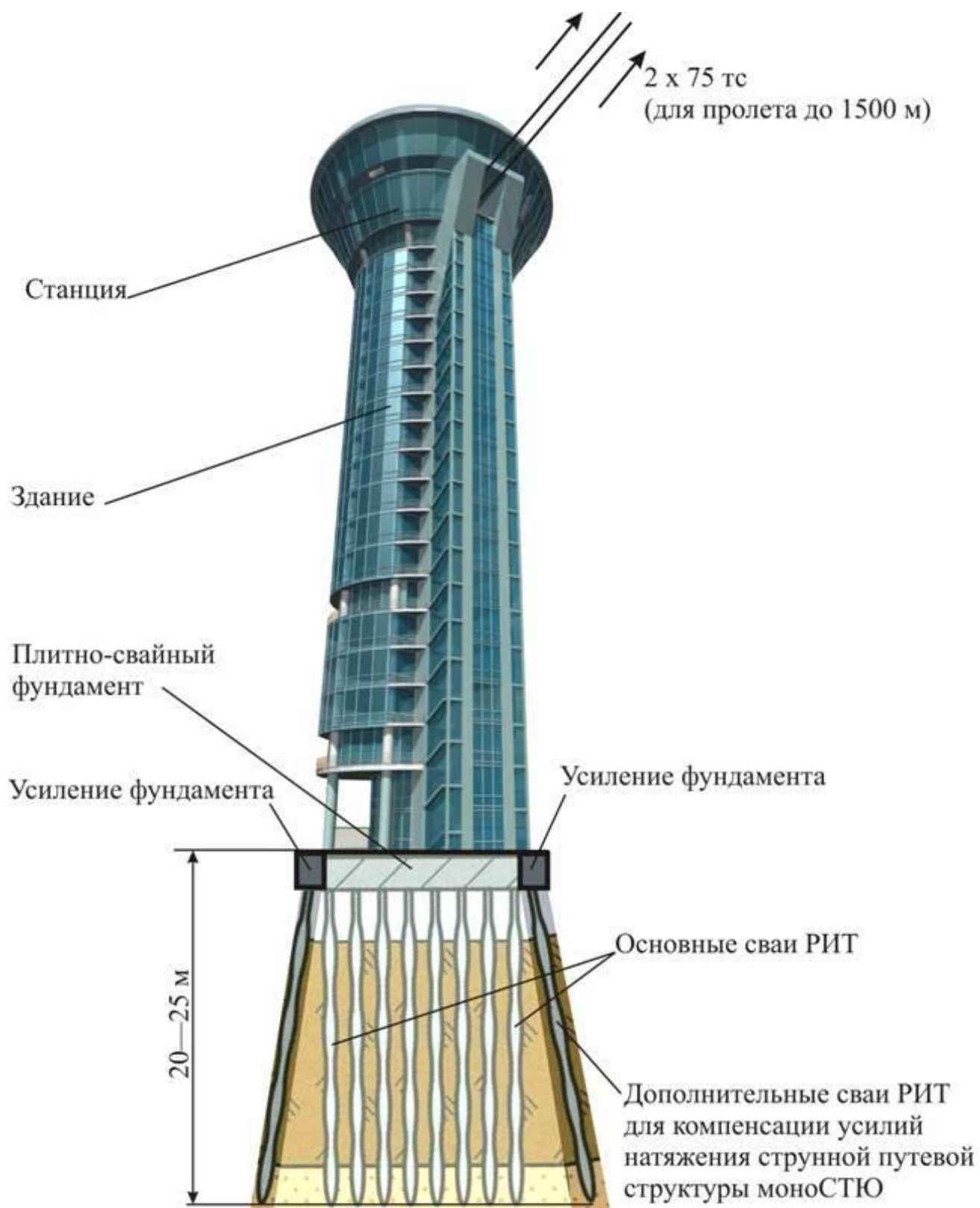
Рис. 1.40. Один из вариантов устройства здания-станции высотной пассажирской двухпутной автоматизированной трассы моноСТЮ для г. Екатеринбурга
