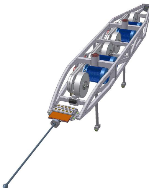
Рис. 1.15. Шасси моно-юнибуса Ю-373П (вид на кормовую часть)
