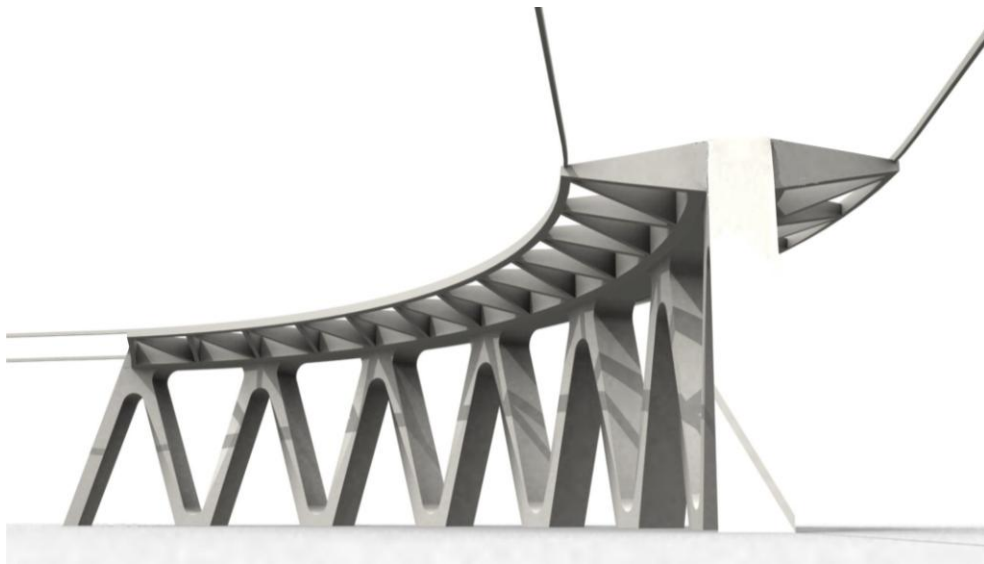
Рис.5. Анкерная опора моноСТЮ, совмещенная с поворотом трассы
