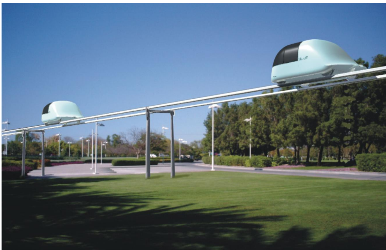
Рис. 4. Однопутный участок двухпутной сверхскоростной трассы миниСТЮ — «Green arrow» в городе
