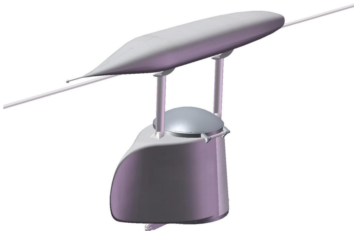
Рис. 3.34. Общий вид высокоаэродинамического моно-юникара (вид с кормы)
