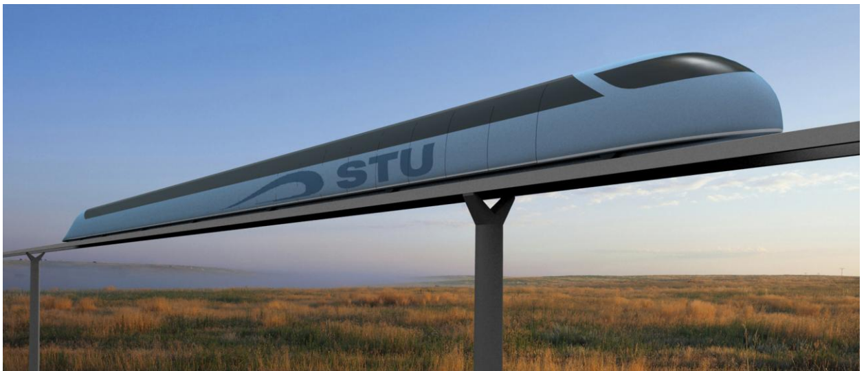
Рис. 2. Высокоскоростная дорога СТЮ Скорость до 360 км/час, колея 0,75 м
