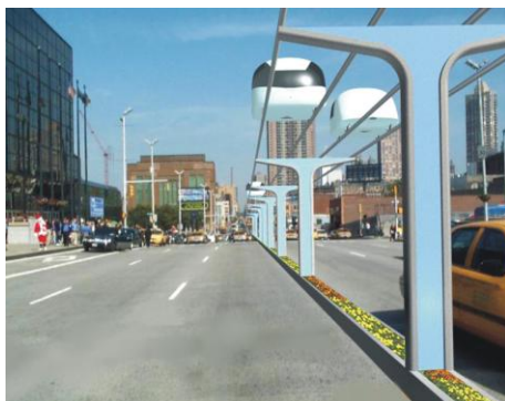
Двухпутный СТЮ в городе, скорость до 120 км/час
