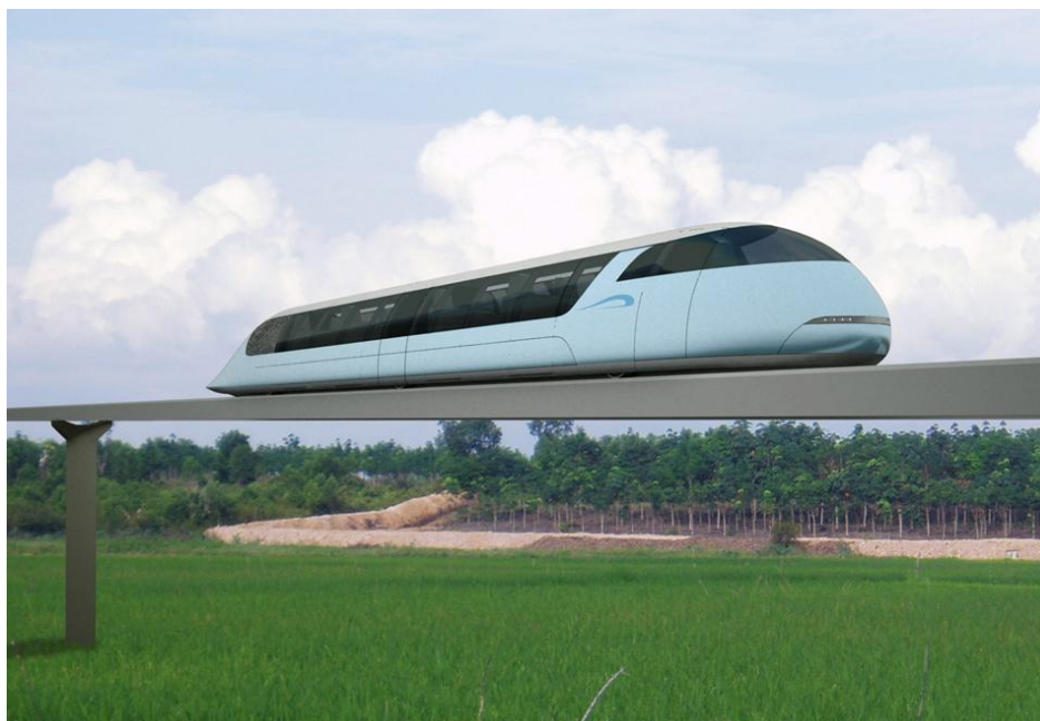
Рис. 28. Пассажирский высокоскоростной юнибус (вместимость 18 пассажиров, расчётная скорость движения 360 км/час)
