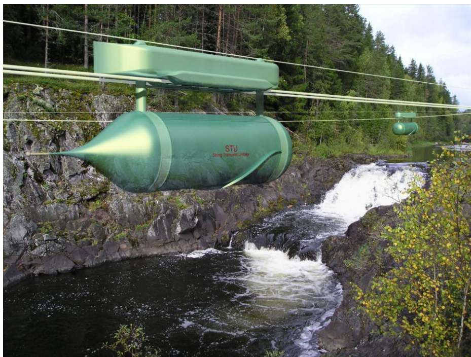
Рис. 29. Грузовой подвесной рельсовый автомобиль (юникар) СТЮ грузоподъемностью 6 т (с тяговым канатом)
