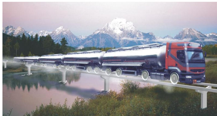
Рис. 13. Грузовой поезд СТЮ для перевозки жидких грузов, созданный на базе традиционного грузового автомобиля
