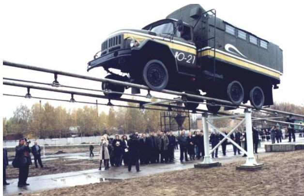
Рис. 48. Модифицированный ЗИЛ-131 на рельсо-струнном пролёте длиной 24 м (октябрь 2001 г.)
