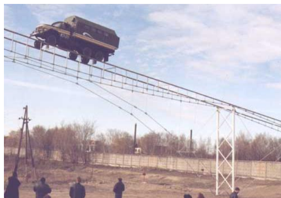
Рис. 49. Модифицированный ЗИЛ-131 на рельсо-струнном пролёте длиной 48 м (ноябрь 2003 г.)
