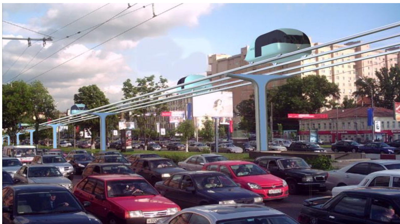
Рис. 3. Двухпутная трасса городского навесного СТЮ (скорость до 120 км/час)
