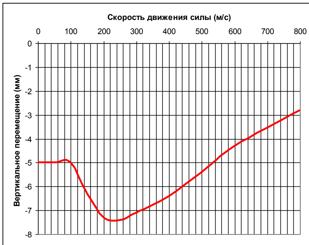
Рис. 3.1.3. График наибольших вертикальных перемещений точки К под силой (условной оси колеса) при разных скоростях движения силы по пролёту
