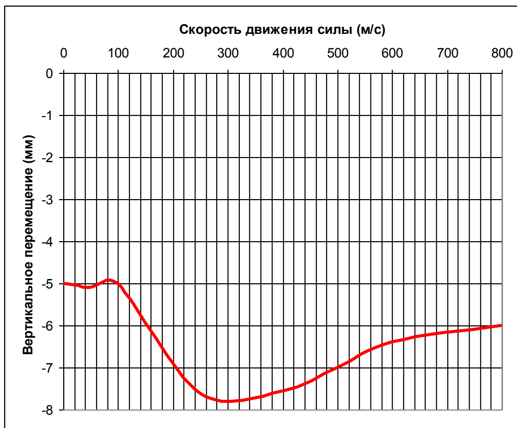
Рис. 3.1.5. График наибольших вертикальных перемещений точки С — середины пролёта фермы-струны при разных скоростях движения силы по пролёту
