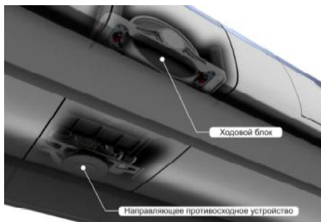
Рис. 4.4. Противосходное устройство и ведущее колесо высокоскоростного навесного модуля
