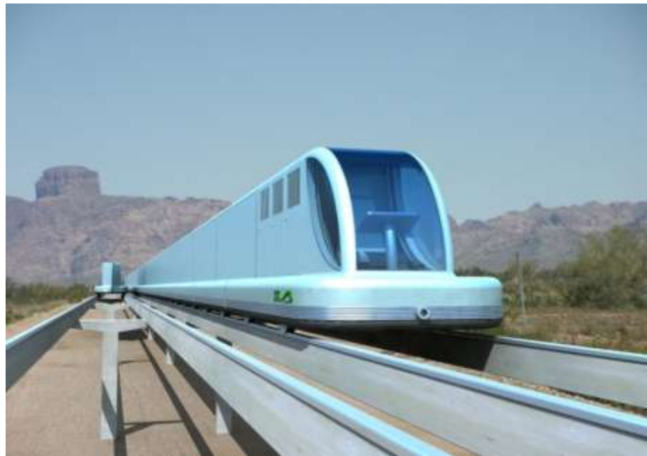
Рис. 1. Навесной STS (показан поезд грузоподъемностью 160 тонн)
