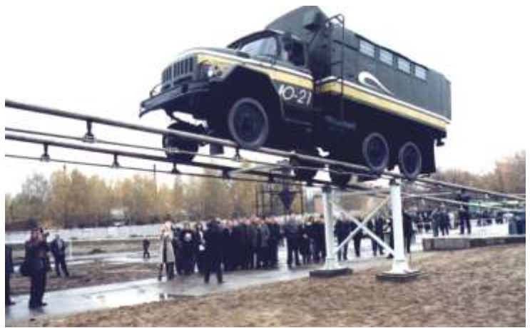
Рис. 3.1. Опытный участок струнного транспорта
