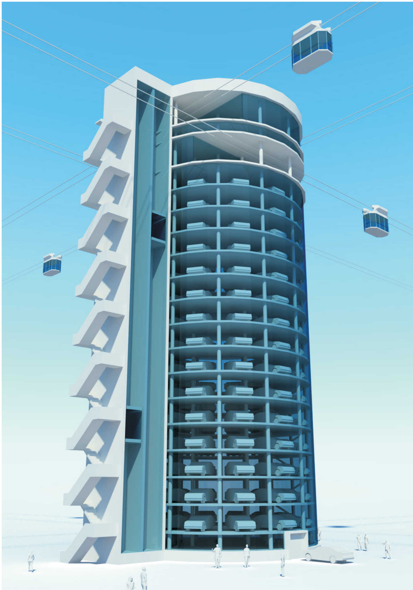
Общий вид станции СТЮ, совмещенной с многоуровневым паркингом с автоматизированной системой хранения автомобилей (вариант 2)
