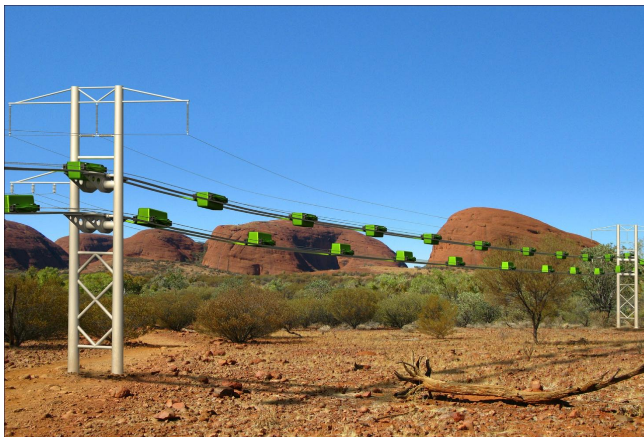
Рис. 8. Грузовая трасса СТЮ, совмещённая с высоковольтной и низковольтной линиями электропередач и выполненная в логике продуктопровода с внешним канатным приводом для перевозки сыпучих грузов
