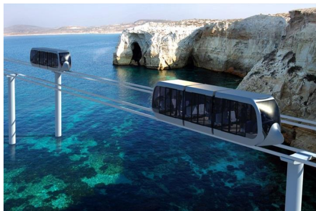
Рис. 7. Пассажирские рельсовые автомобили технологии SkyWay — юнибусы (слева высокоскоростные междугородные, скорость до 500 км/ч, справа — городские, скорость до 150 км/ч)
