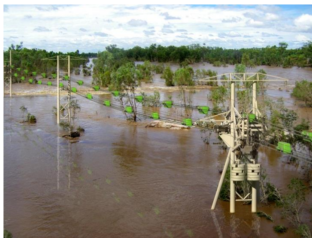
Рис. 8. Грузовые рельсовые автомобили технологии SkyWay — юникары (слева — навесная система с движением по струнной ферме автопоездов с локомотивной тягой, справа — подвесная система с движением несамоходных тележек с внешним приводом посредством канатной тяги)
