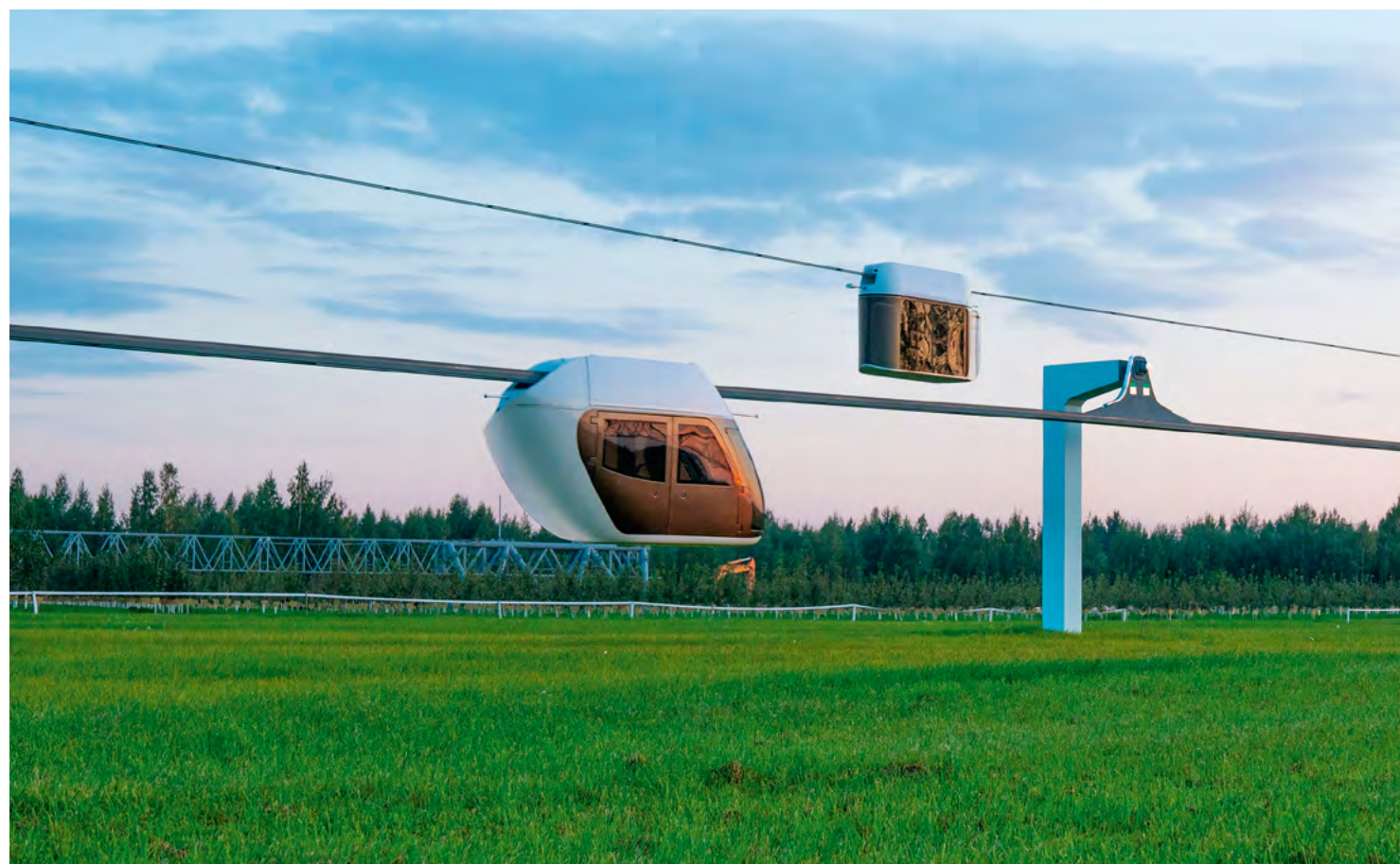
Юнибус и юнибайк – образцы подвижного состава струнного транспорта SkyWay – на испытаниях в демонстрационно-сертификационном центре компании-разработчика в ЭкоТехноПарке (Минская область, 2017 год)
