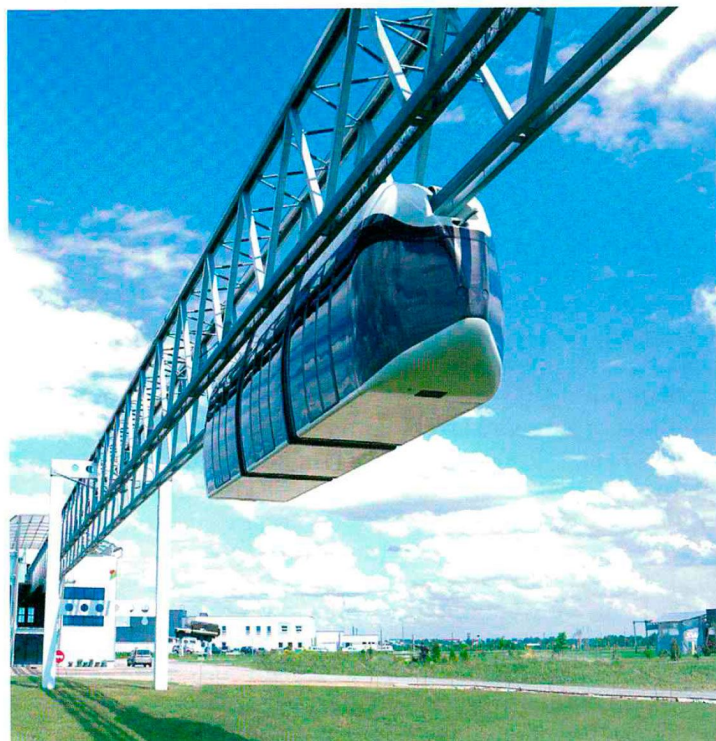
▲ Четыре тестовых участка инновационных дорог построены и функционируют в Марьиной Горке. Модулями управляет что-то вроде искусственного интеллекта, который уже разогнал их до 100 км/ч на участке около 1 км. В реальных условиях на больших отрезках они смогут развивать скорость до 150 км/ч в городской черте.
