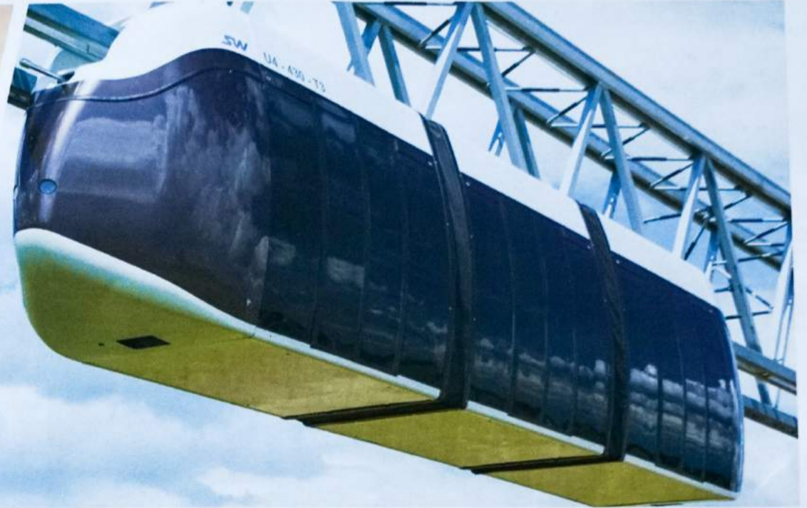
▲ 18-местный транспортный модуль SkyWay на ферменной эстакаде (Беларусь, Минская область)
